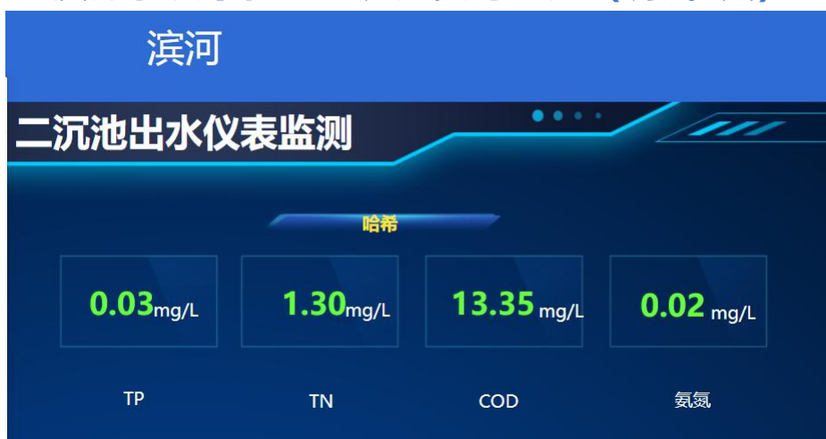
滨河水质净化厂二沉池实时监测（调试5天）
