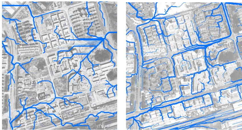
10m 网格精度（左）与 2m 网格精度（右）地表径流路径模拟结果对比
